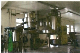
Wirbelstromtrockner mit Siebanlage
