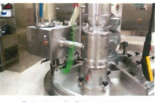
Siebanlage für Pulvermischer
