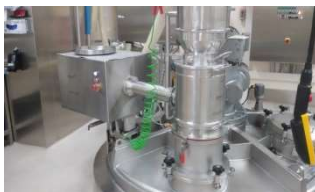
Siebanlage für Pulvermischer
